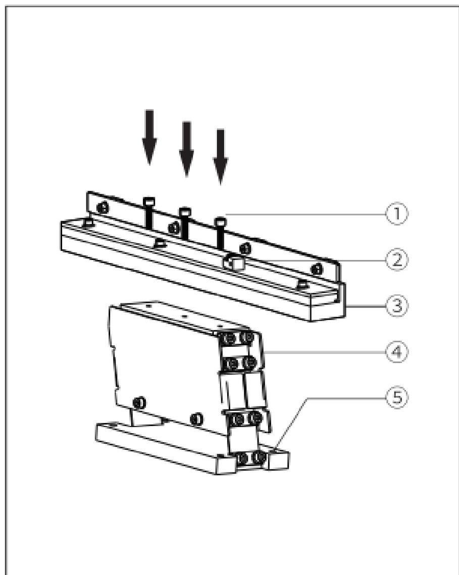
①滑轨锁紧螺丝 ②光纤支架 ③直线滑道 ④直线振动器底座
